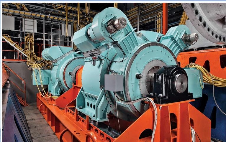
**02** Der Rotor eines permanentmagneterregten Wellengenerators ist zum Großteil hohl, was zur Verringerung des Trägheitsmoments und der Rotationsmasse des Antriebsstrangs beiträgt
