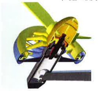
Beim Magnetringerenerator (links) sind Rotor (gelb) und Stator (blau) magnetisch gelagert. In der Versuchsanordnung (rechtes Bild) untersuchen die Forscher aus Magneteilgeräten und die aufzutretenden Kräfte
